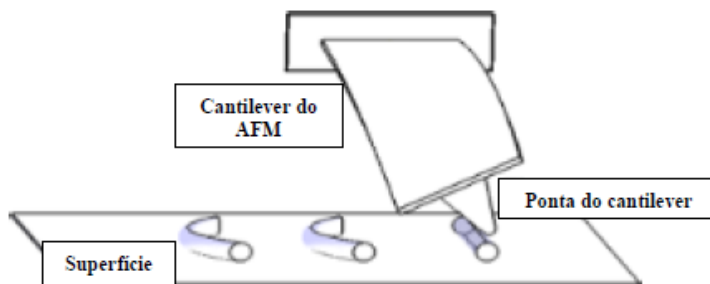
Figura 11 - Esquema ilustrativo de manipulação de nanopartículas usando microscópio de força atômica. Adaptado 66 .
