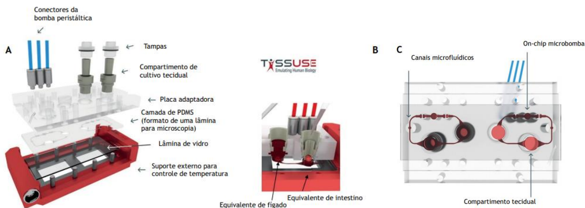
Figura 19 - Esquema ilustrativo de um modelo "organs-on-chips". A. Desenho esquemático do modelo do dispositivo microfluídico TissUse 2-OC ( www.tissuse.com/en/products/2-organ-chip/ ). B. Vista de um corte longitudinal do 2-OC mostrando os compartimentos de cultivo de equivalentes de intestino e fígado. C. Vista inferior do 2-OC com destaque para os canais microfluídicos que interconectam os compartimentos de cultivo tecidual. Adaptado 122 .
