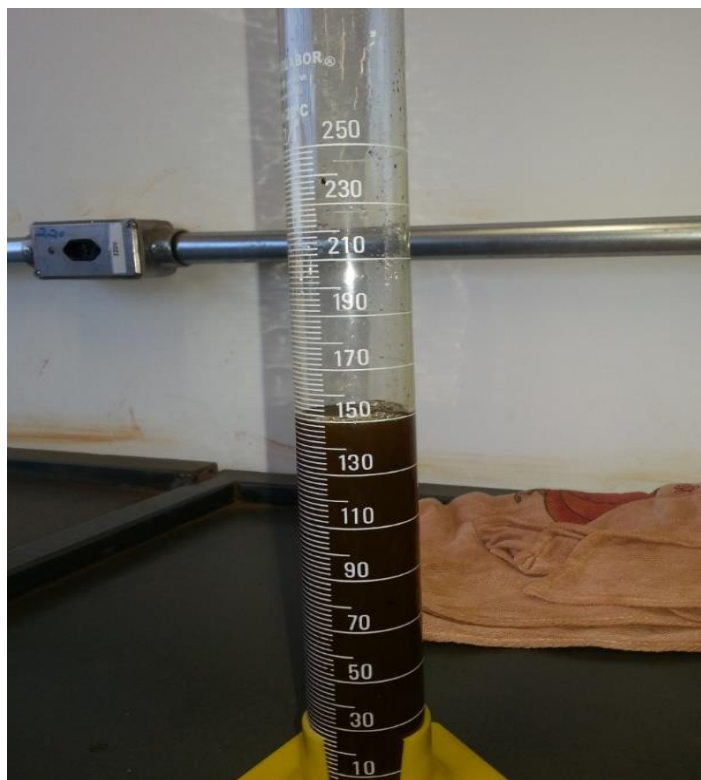
Figura 2.6 - Proveta contendo melaço no volume inicial de 150 ml, padrão para todos os experimentos realizados.
