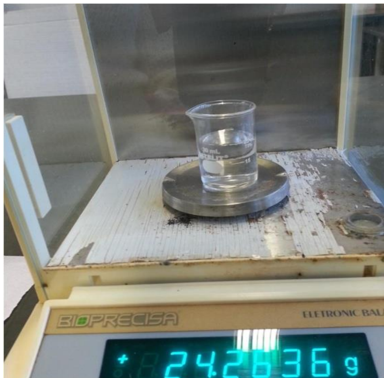
Figura 2.2 - Medição da massa de água na balança digital em um volume de 25 ml.
